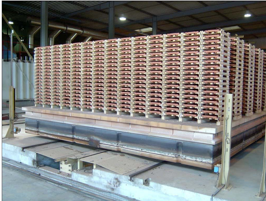
Figure N°20 : wagon de tuiles pour la cuisson (CTTB, 2006)
